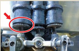
油汚れ等でバーナーの給気口が塞がれ、不完全燃焼を起こします。
